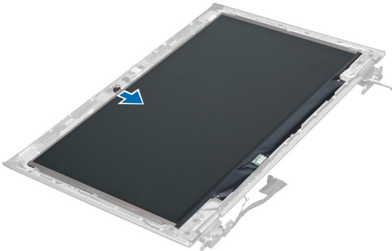
4. Retire os parafusos que fixam o painel do ecrã à tampa posterior do ecrã.
