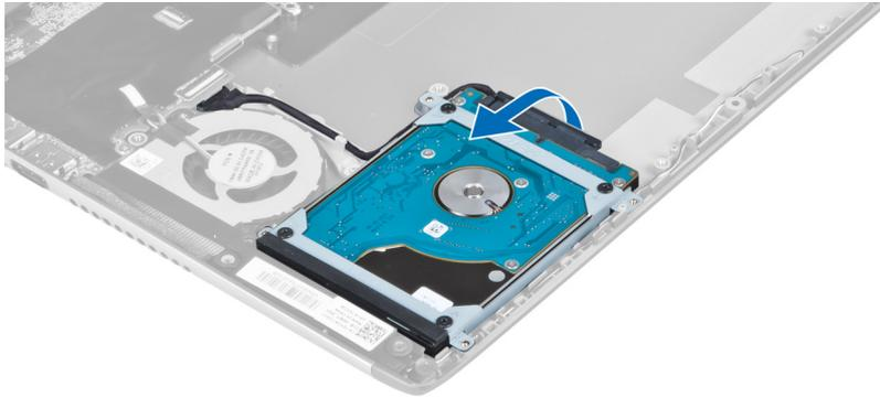
5. Desligue o cabo da unidade de disco rígido e depois retire-a do computador.
