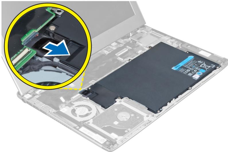
4. Retire os parafusos que fixam a bateria à placa de sistema.
