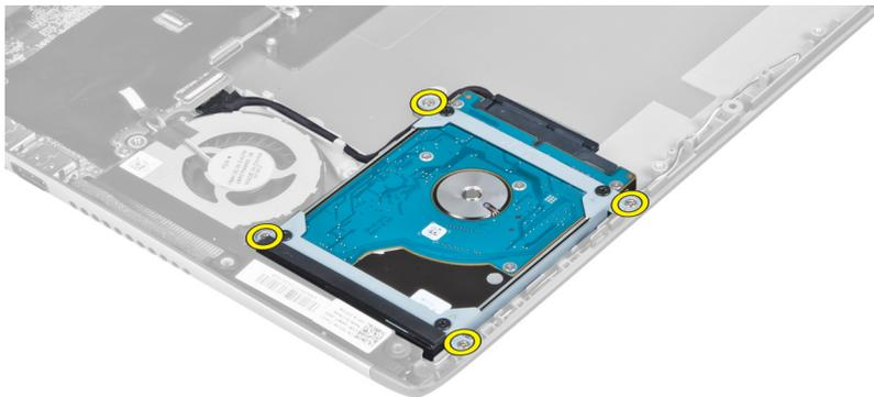
4. Levante a unidade de disco rígido para desligar o respectivo cabo.
