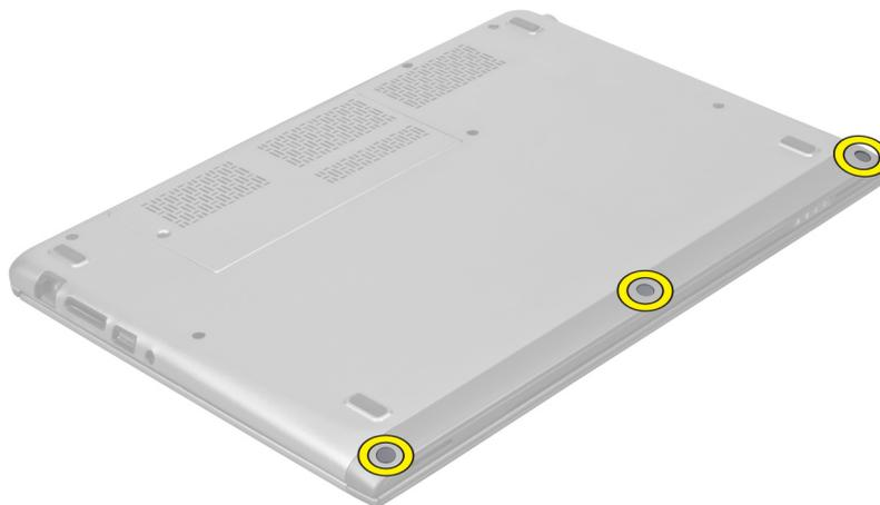
4. Retire os parafusos que fixam o apoio para as mãos ao computador.
