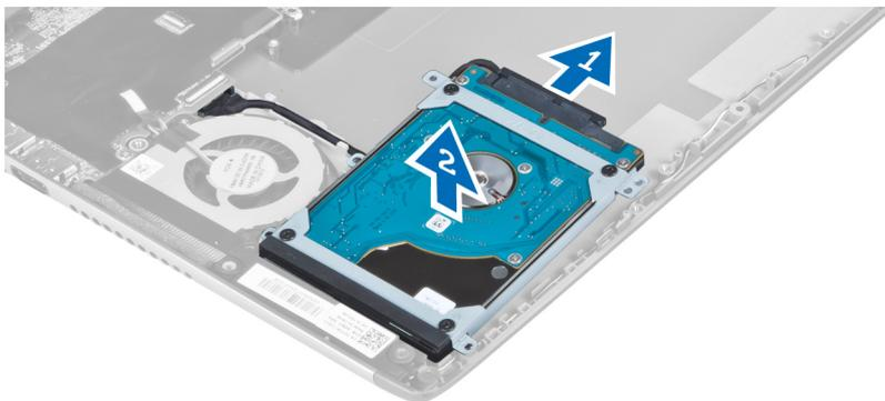
6. Remova os parafusos que fixam o suporte da unidade de disco rígido à unidade de disco rígido e remova o respectivo suporte.
