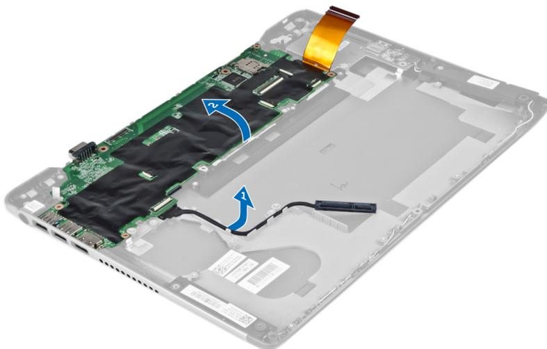
6. Desligue da placa de sistema o cabo do conector de alimentação.
